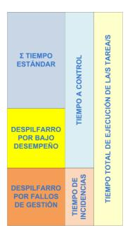
Para poder calcular el despilfarro en fabricación será necesario un control de todos los componentes del tiempo que se muestran en la figura anterior. Y a este control se le llama Control de la productividad, se podría definir como:
